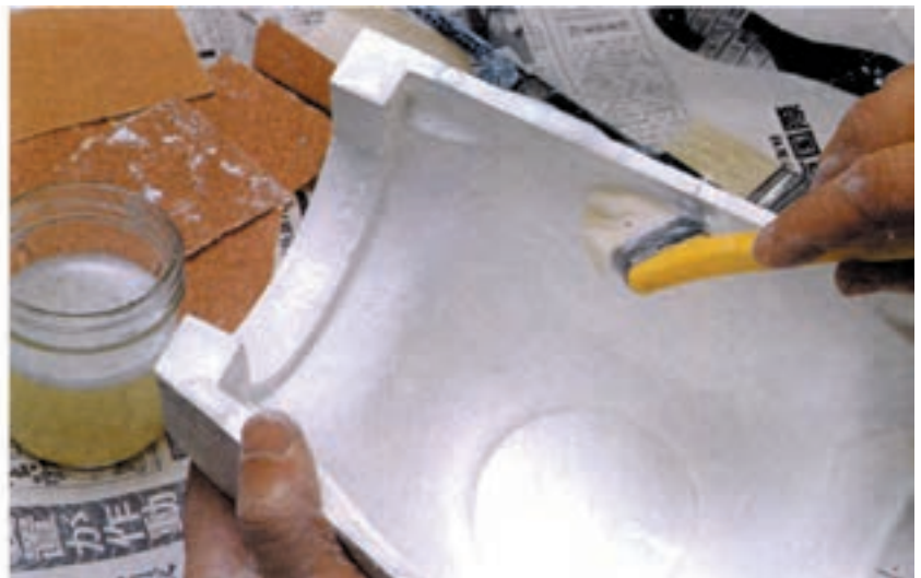
۱۴- مرحله ایجاد لایه جداکننده سطح داخلی قالب را برای جدا شدن به صابون مایع آغشته کنید.
