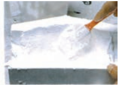
۱۶- گچ را درون قالب یک دست کنید.
