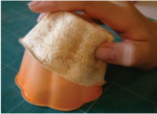
۴- خروج قطعه از روی مدل
